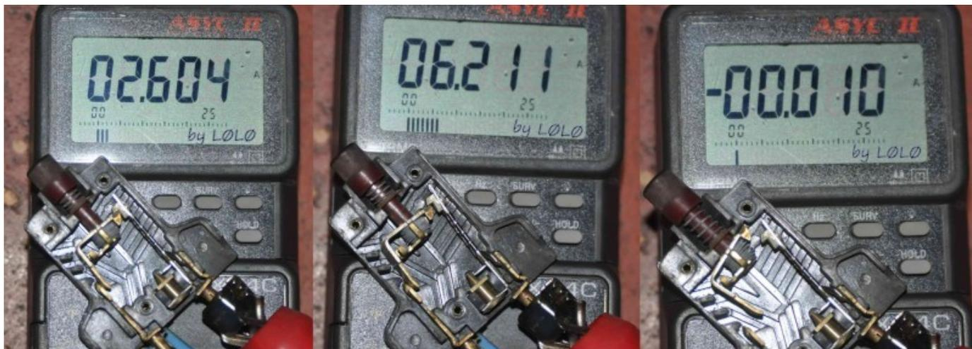
Petit test, avec une alimentation dont je peux faire varier le courant jusqu'à 6 A et un ampèremètre placé en série avec le fusible E-T-A de 4A .
