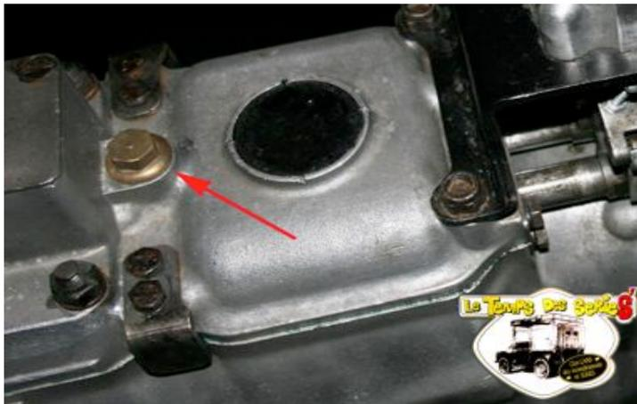
Selon le même principe, le bouchon bronze du milieu retient lui aussi un ressort de pression pour la fourchette centrale. Le dévisser avec une clé impériale de 19/32" ou métrique de 15.
