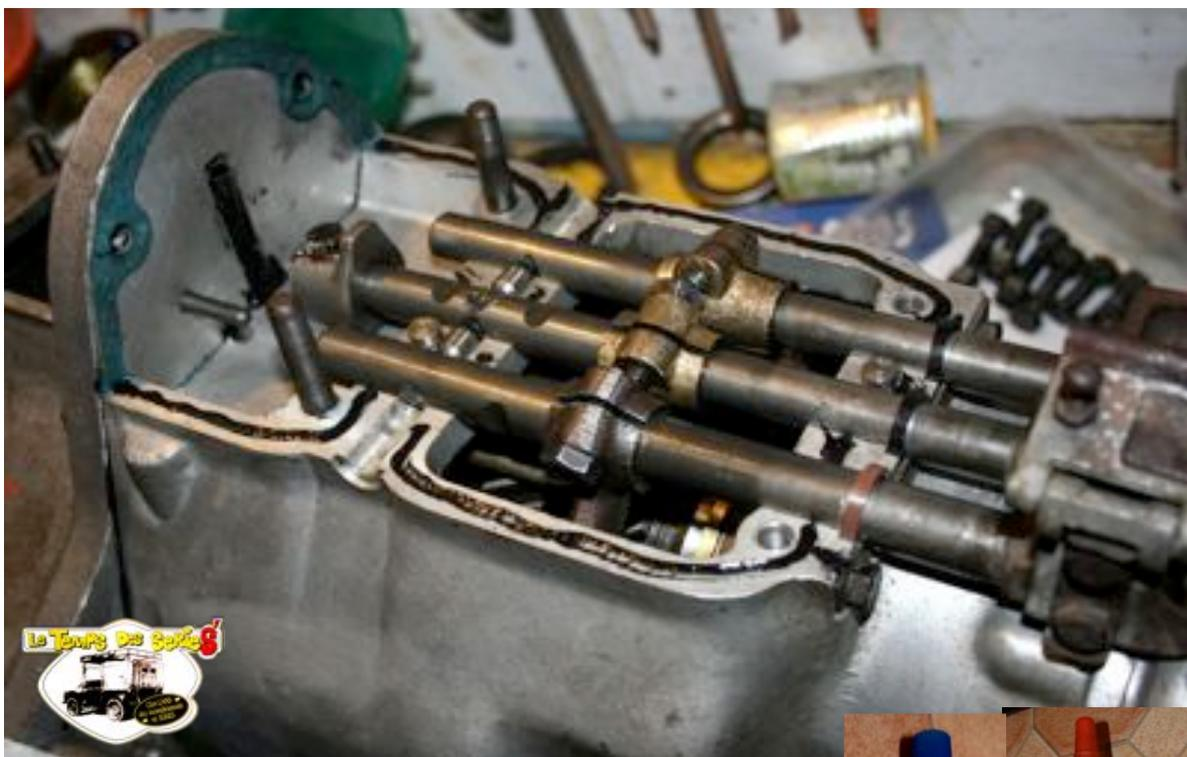
Dans le cas ci-dessus le joint papier arrière n'a pas souffert au démontage, pour plus d'efficacité on pourra l'enduire, sinon le décoller proprement et le remplacer par du joint moteur.
